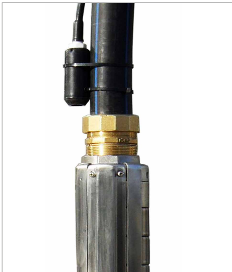
Figure 21 : fixation de la sonde de puits
